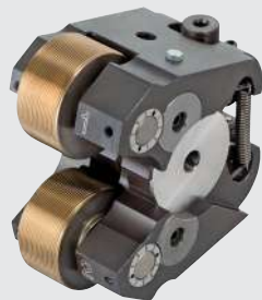
2 Tangential-Gewinderollen und Einstelllehre (für jede Gewindeabmessung sind ein Rollensatz und eine Einstelllehre erforderlich) Tangential thread rolls and setting gauge (each thread size requires one set of rolls, and one setting gauge)
